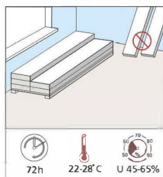
Acclimatare il pavimento
